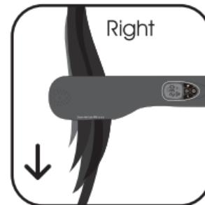
Apertar os cabelos entre as pinças: o aparelho iniciará a distribuir vapor automaticamente. Fazer com que a prancha deslize lentamente desde a raiz até às pontas dos cabelos para que o vapor possa ser aplicado ao longo de toda a madeixa.
