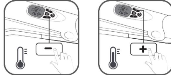
**Das Aufheizen des Geräts bis zur Höchsttemperatur (230°C) dauert ungefähr 2 Minuten.**
